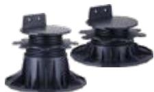
Stufenlos höhenverstellbarer Träger zum Höhenausgleich & Unterbau von Unterkonstruktionen. Pro Meter Unterkonstruktion werden ca. 2 Träger benötigt. Erhältlich für die Ausgleichniveaus: Stageless adjustable bases to bridge over vertical heights. Per meter substructure you need 2 bases. Available for this vertical height ranges: 18-33mm | 34-70mm | 65-140mm | 140-220mm
