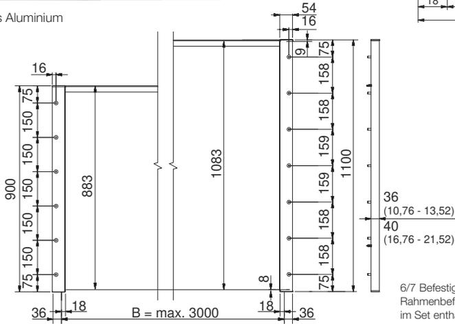
6/7 Befestigungsbohrungen pro Profil, für Rahmenbefestigung, Kantenschutz nicht im Set enthalten.
