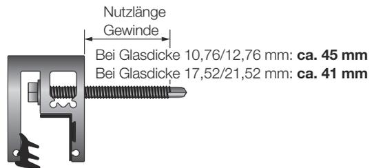
Zusätzlich bieten wir auch separat zu bestellende Bohrschrauben in alternativen Längen an:
