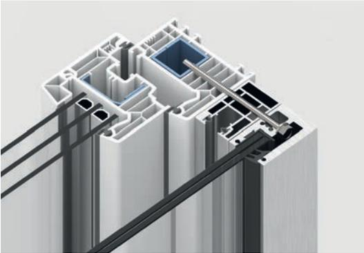
Beispiel für Befestigungstyp K mit längeren Bohrschrauben: Montage durch Rolladenführungsschiene aus Aluminium und Verankerung in der Stahlarmierung des Kunststofffensters
