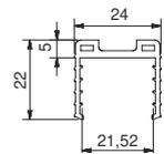
**Elastomerprofil für U-Profil**
