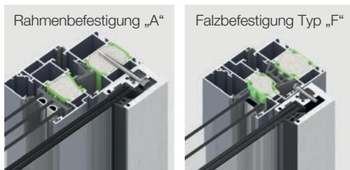
**Tipp 2:** Falls die Hohlkammer der Rahmenprofile von Wärmedämmung, Putz oder Mauerwerk verdeckt wird kann bei Aluminiumfenstern auf die Falzbefestigung (Befestigungsvariante „F“) ausgewichen werden. So rücken die Profile weiter ins Licht und die Glasbreite reduziert sich dementsprechend.
