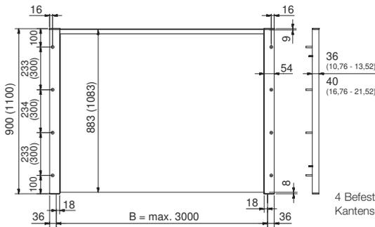
4 Befestigungsbohrungen pro Profil, für Rahmenbefestigung, Kantenschutz nicht im Set enthalten
